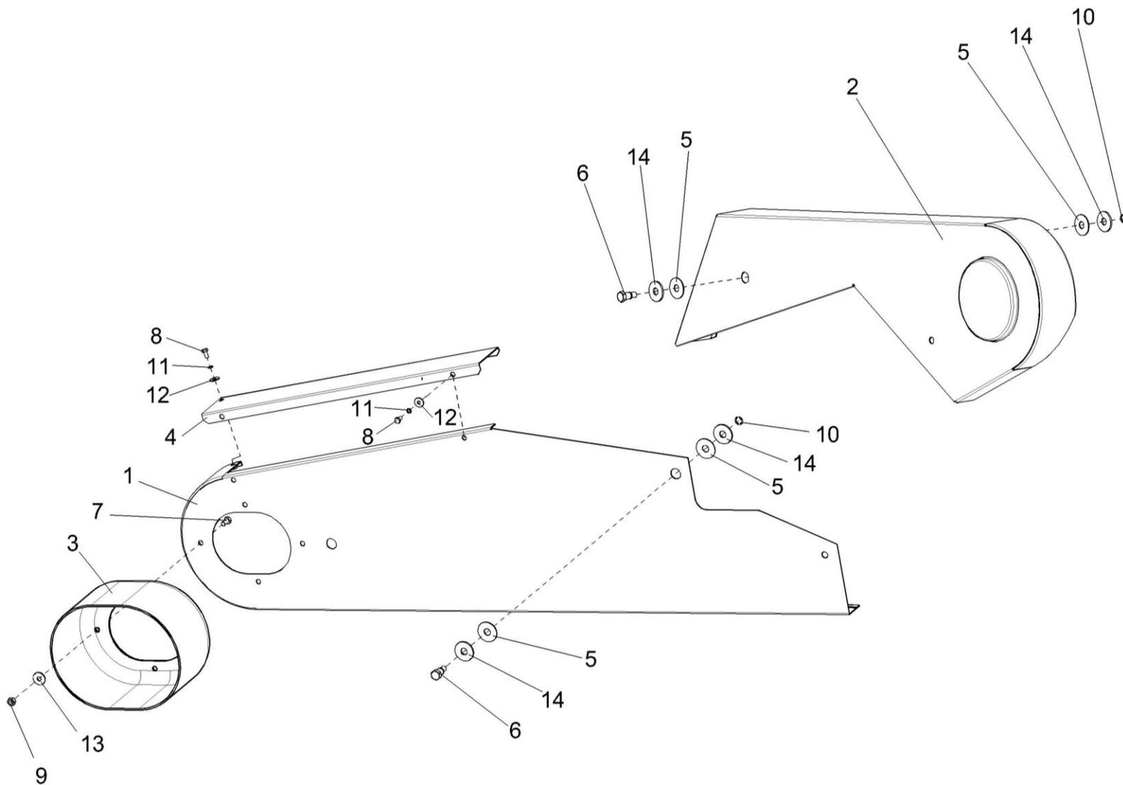
Рисунок 6 – Ограждение КЗК-12-1800140 и ограждение КЗК-12-1800160
