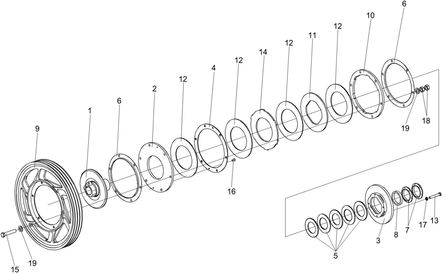
Рисунок 3 – Муфта предохранительная КЗК-10-0502090
